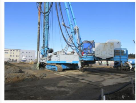
静的締固め砂杭工法
